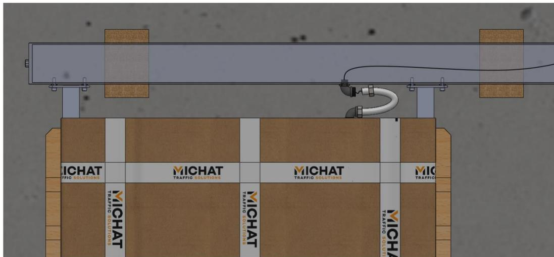
3. Placer le raccord coudé orienté vers le bas, même s'il n'est pas serré à fond.
