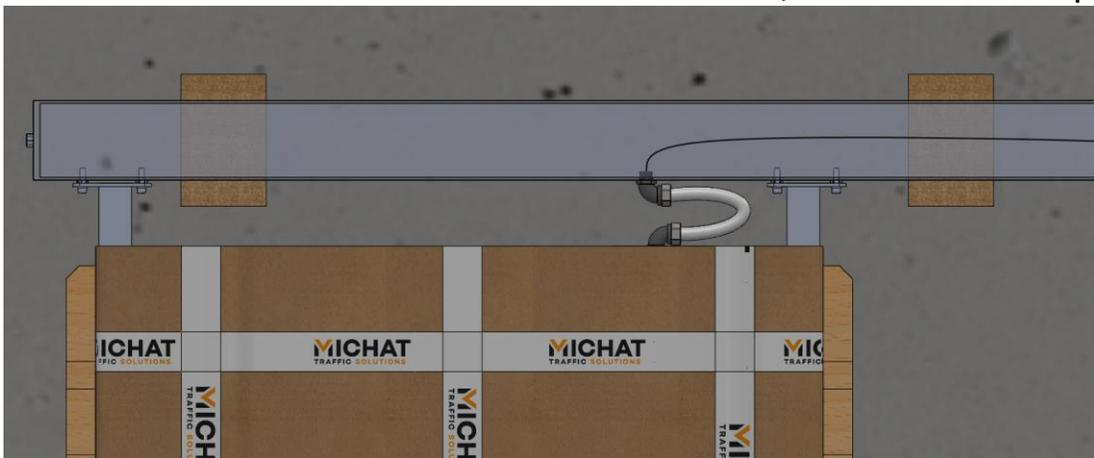
4. Tirer sur le câble par la trappe pour l'engager complètement jusqu'à ce que la gaine soit en bonne position dans le raccord et serrer l'écrou.
