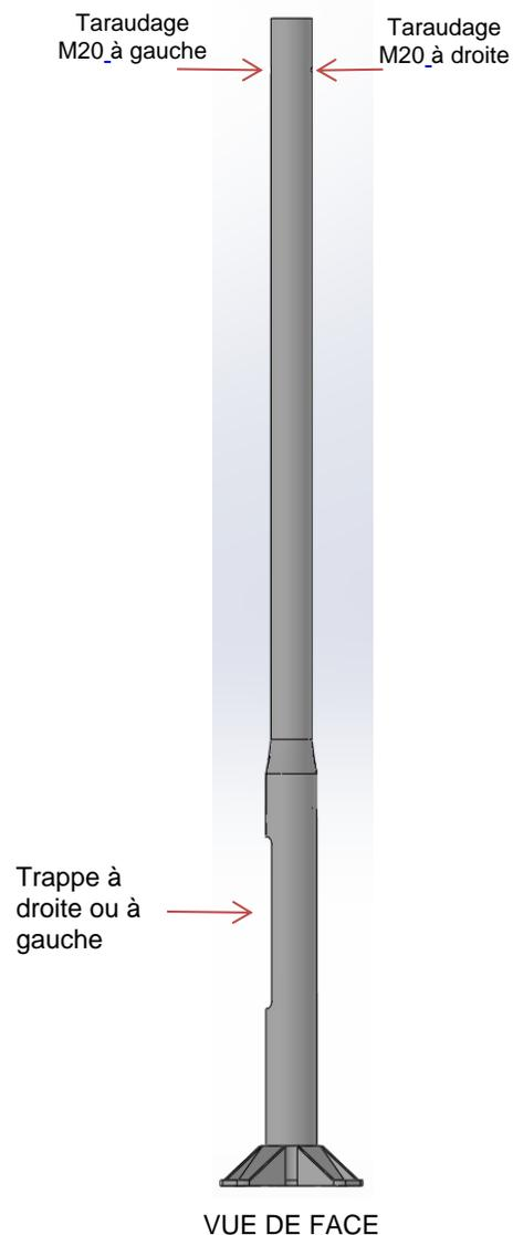
Le mât doit être positionné comme représenté sur l'image ci-contre, à savoir avec les trous taraudés M20x1.5 à droite et à gauche du mât. La trappe située en pied de mât peut se trouver à droite ou à gauche, en fonction de ce qui est judicieux pour le site.
