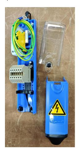
6. Raccordement des câbles dans le coffret au niveau de la trappe
