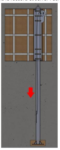
6. Placer le crochet de la grue dans l'anneau de levage à visser en tête de mât et procéder à la mise en place sur les ancrages.
