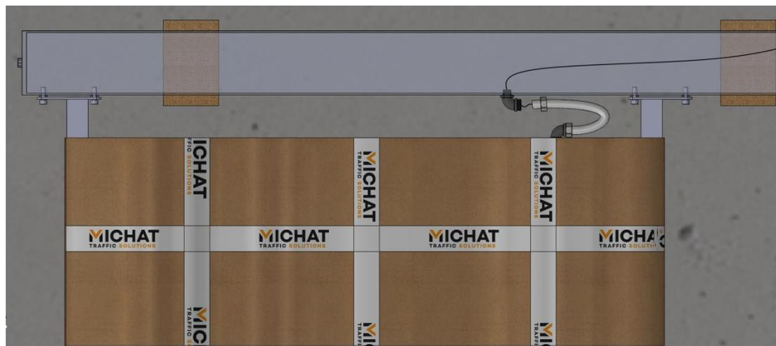
3. Placer le raccord coudé orienté vers le bas, même s'il n'est pas serré à fond.
