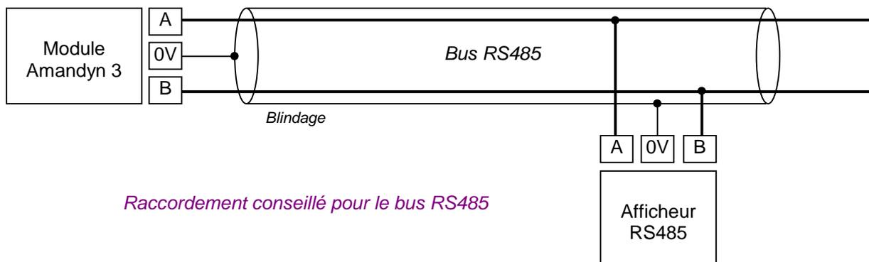
**!** ► Si le câble utilisé ne comporte pas de blindage ou d'écran et en cas de problème de communication avec les afficheurs, il peut être nécessaire d'effectuer une équipotentielle entre la borne "0V" du coffret et le "0V" des afficheurs en utilisant un conducteur supplémentaire.
