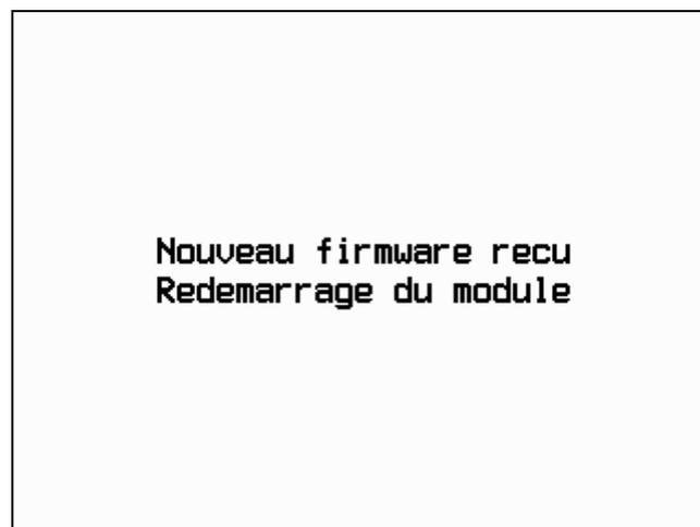
Au bout de trois secondes, le module redémarre et la LED **STATUS OK** clignote lentement pour indiquer que le module efface la mémoire du microcontrôleur.
