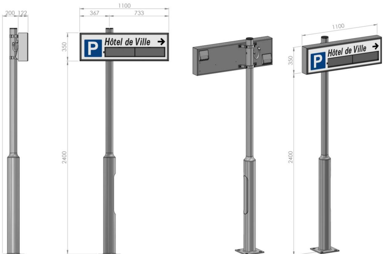
Modèle présenté de type "Mât à gauche" - La version "Mât à droite" est symétrique.
